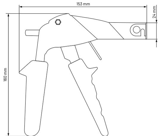
Alicates ideados especialmente para el anclaje metálico expandible con tornillo AEP. Su funcionamiento es intuitivo y sencillo.
